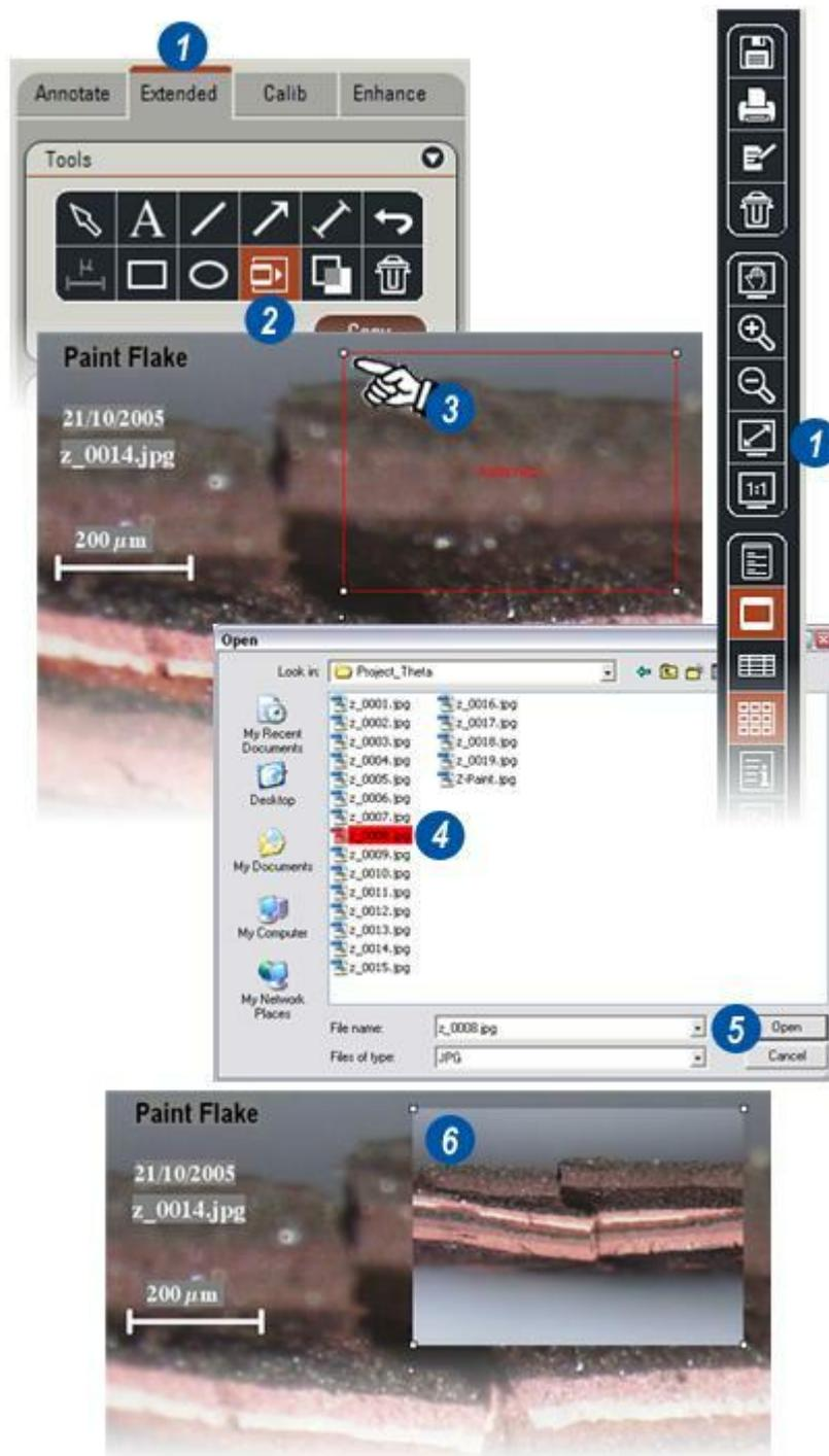
Il est possible de tracer des formes et des lignes sur des images. Dans cet exemple, un cercle sur l'image insérée indiquera la fissure de l'écaïlle de peinture et un trait partant du cercle pointera vers la fissure agrandie sur l'image principale.
