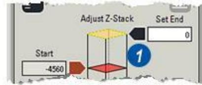
**2** : Faites une mise au point sur la partie du spécimen qui constitue le dernier pas Z en utilisant les commandes manuelles du microscope ou l'interface *Leica Application Suite*. La flèche *Fin* se déplace le long de la série virtuelle en réponse au microscope.
