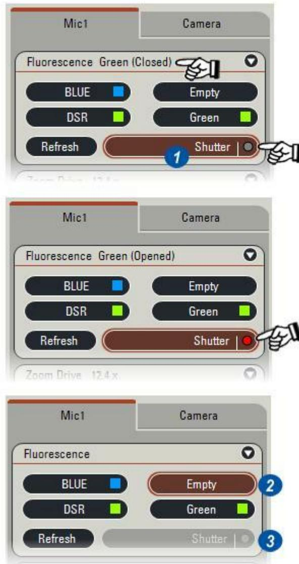
**1** : Placez le pointeur de la souris au-dessus du bouton *Filtre* pour afficher sa spécification (**2**). Cliquez sur le bouton : la *roue porte-filtres* tourne alors pour activer le filtre.
