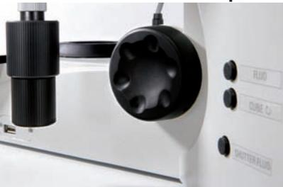
La disposition des commandes de mise au point et de la platine permet d'utiliser confortablement les réglages x, y et z, d'une seule main.
