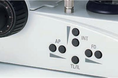
Le gestionnaire d'éclairage est facilement accessible, du côté gauche du microscope. On peut ainsi modifier selon ses besoins les réglages pour l'intensité lumineuse, les diaphragmes d'ouverture et de champ.
