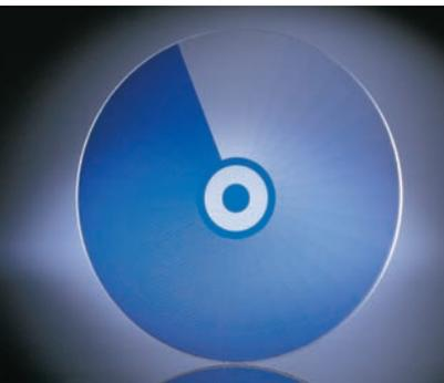
Le module CCIC intégré à l'axe transmis se compose d'une plaque de verre avec un filtre bleu de graduation croissante. Par une position adaptée à la tension de la lampe, le module génère une température de couleur constante même si la tension de la lampe est faible.
