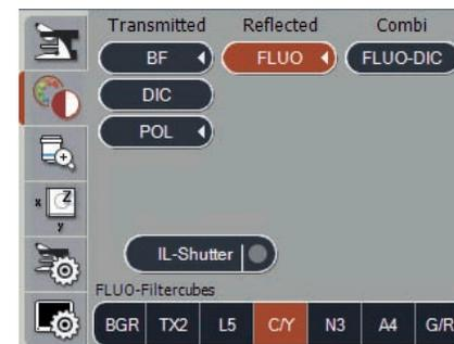
Page Contraste du Leica SmartTouch. C'est ici que s'effectue le changement de contraste par simple effleurement.
